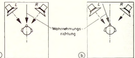
Bild 6. Stereophonische Wiedergabe: a) beide Lautsprecher strahlen den gleichen Schalldruck ab (Schallquelle in der Mitte), b) beide Lautsprecher strahlen unterschiedlichen Schalldruck ab (Schallquelle nach links verschoben)
